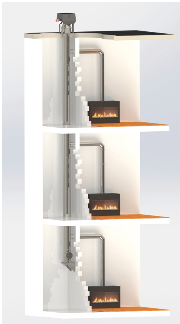
CSG-opstelling in onderdruk met concentrische aansluitingen 80/125 en collectieve ventilator op het dak.
